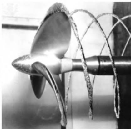
(d) Tip vortex cavity
